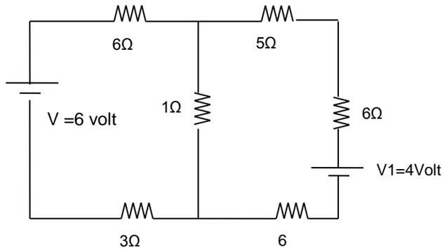
**2. Utiliza solo mallas para resolver el circuito**
